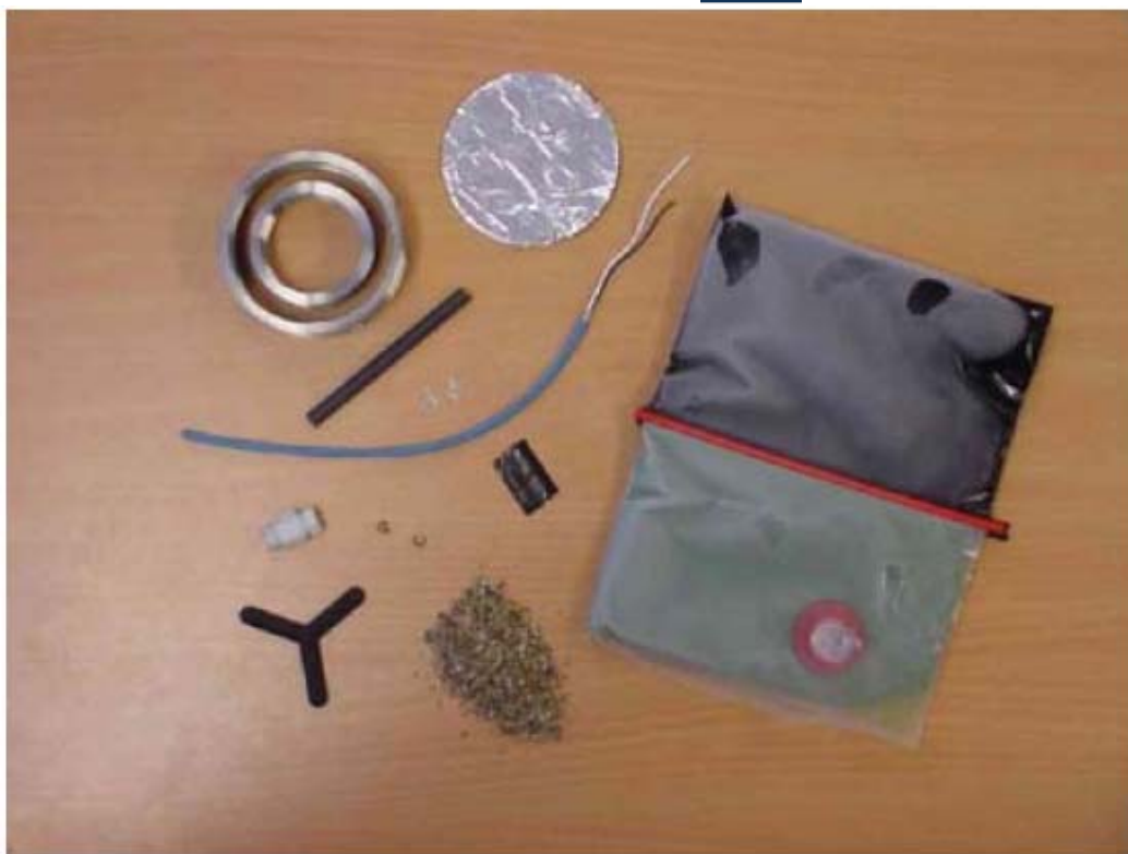
Figuur 2 - Materialen voormontage geleidbaarheidsensor
