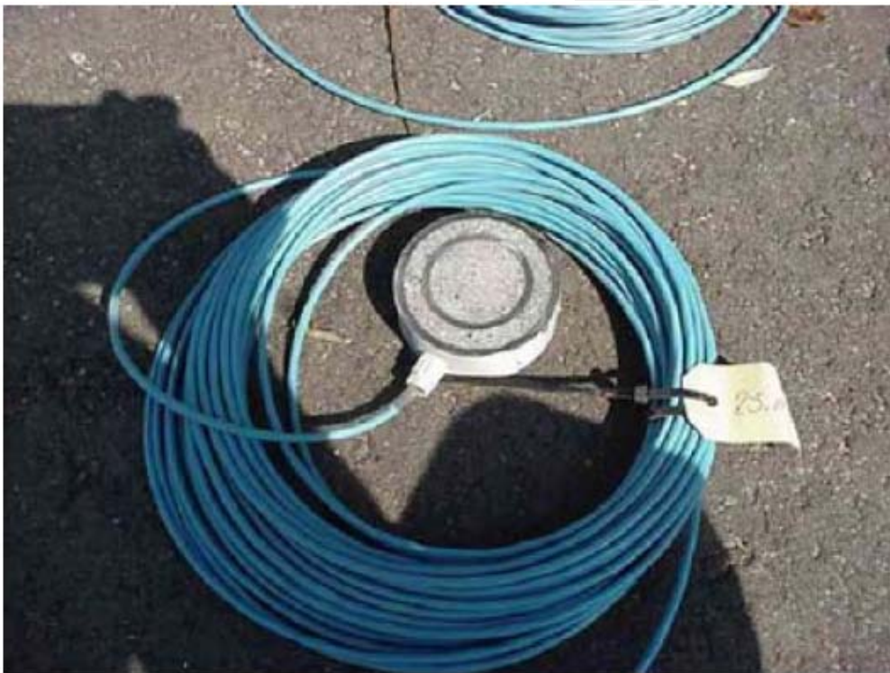
Figuur 7 - Eindresultaat geleidbaarheidsensor
