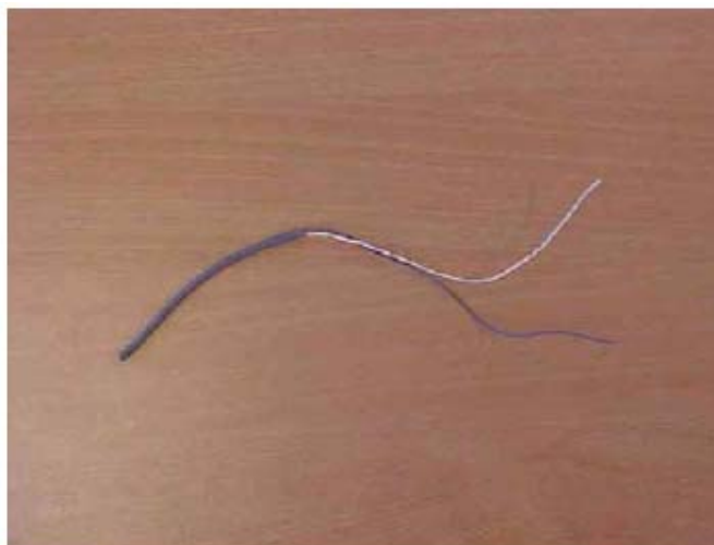
Figuur 9 - Afgeknipte en gestripte temperatuursensor
